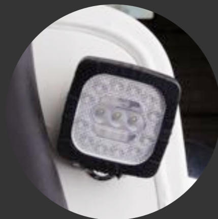
Oświetlenie robocze LED
