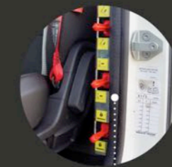
Steuerung des Hakenliftes aus der Kabine
